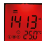
Im Alarmzustand / Alarm condition
